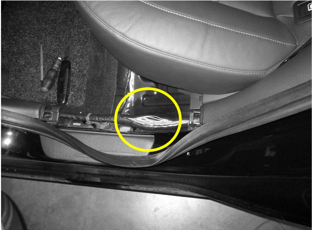
In Höhe des hinteren Türschweller (Fahrerseite) das Bougierrohr öffnen, die beiden Leitungen der Nebelschlussleuchten ermitteln (ausmessen) und an geeigneter Stelle trennen.
