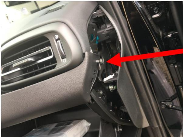
SCHRAUBE HINTER DER ABDECKUNG ENTFERNEN
