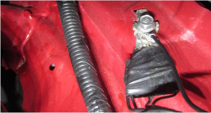
Das Massekabel unterhalb des Scheinwerfers mit der M6 Schraube befestigen.
