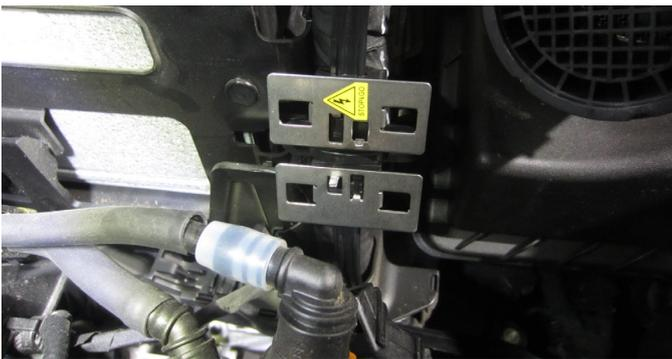
Die fünfte Kontaktplatte am Kabelstrang des ECU neben der Batterie mit Kabelbindern befestigen.
