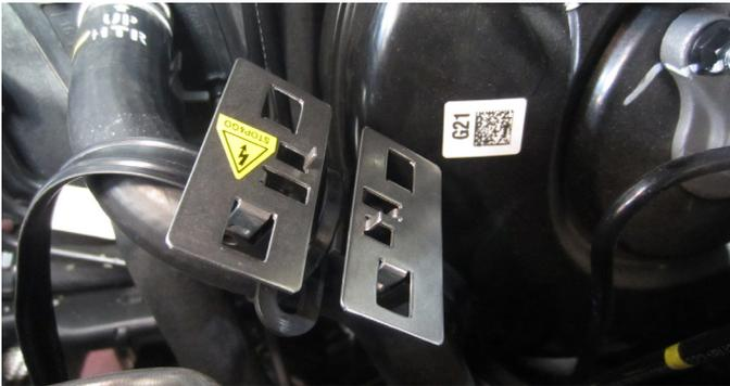
Die vierte Kontaktplatte mit Kabelbindern am Wasserschlauch unten beim Wärmetauscher befestigen.
