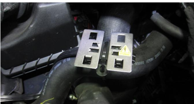
Die letzte Kontaktplatte an den Wasserschlauch oben links beim Motorkühler mit Kabelbinder befestigen. Kabelüberstand abschneiden.
