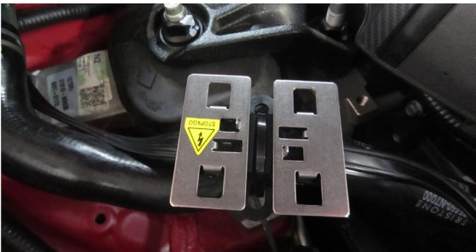
Die erste Kontaktplatte mit Kabelbinder an dem Wasserschlauf des Kühlwasserbehälter befestigen.
