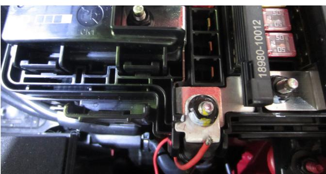
Das Pluskabel am Motorraum Sicherungskasten B+ anschließen.
