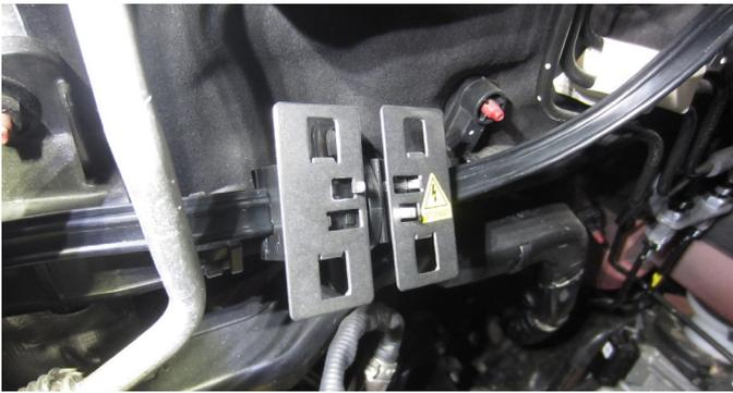
Die dritte Kontaktplatte am Kabelstrang der Spritzwand mit Kabelbindern befestigen.
