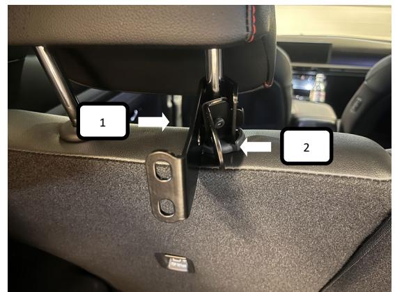
Gumminoppen wie auf dem Bild in die Winkelstütze Haken (Pos. 1) und auf die Winkelstütze Klemmbacke (Pos. 2) drücken.
