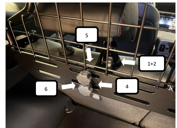
Jetzt von der linken Seite aus eine Schlossschraube (Pos. 5) durch die Winkelstütze (Pos. 1+2) und Winkelstütze stecken, von der anderen Seite jeweils eine Unterlegscheibe (Pos. 4) und Rändelmutter (Pos. 6) aufschrauben und festziehen.
