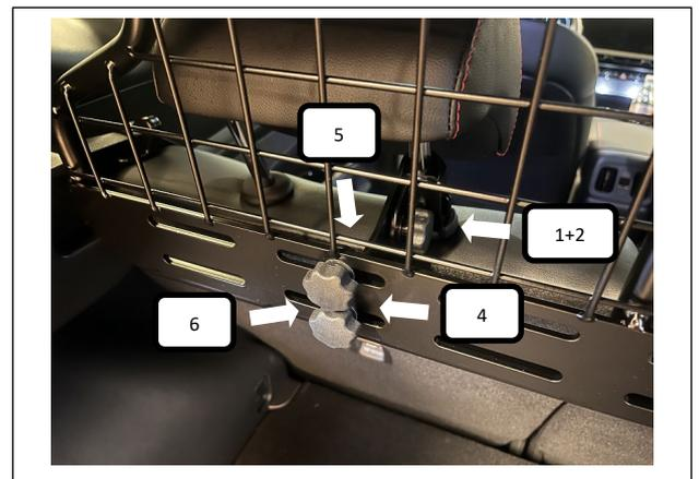
Das Trenngitter an die montierten Winkelstützen (Pos 1+2) halten und vom Fahrgastraum eine Schlossschraube (Pos. 5) durchstecken, von der anderen Seite jeweils eine Unterlegscheibe (Pos. 4) und Rändelmutter (Pos. 5) aufschrauben und festziehen.
