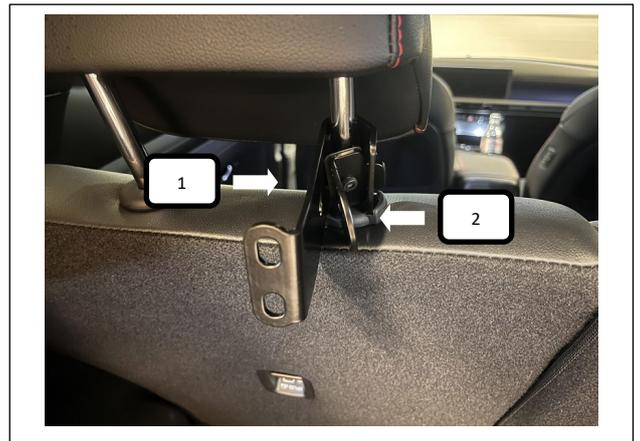
Jetzt die Winkelstütze Haken (Pos. 1) um die Kopfstützenstangen führen und dann die Winkelstütze Klemmbacke (Pos. 2) einhängen.
