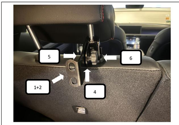
Jetzt von der linken Seite aus eine Schlossschraube (Pos. 5) durch die Winkelstütze (Pos. 1+2) und Winkelstütze stecken, von der anderen Seite jeweils eine Unterlegscheibe (Pos. 4) und Rändelmutter (Pos. 6) aufschrauben und festziehen.
